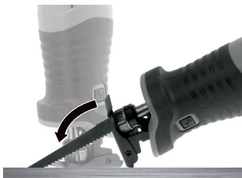
**¡ATENCIÓN!** Riesgo de daños en la unidad. Un corte de incisión solo se puede realizar en materiales más blandos (por ejemplo, madera, yeso). Para materiales más duros, se debe realizar una perforación o agujero adecuado para que la hoja de la sierra pueda iniciar el trabajo.
